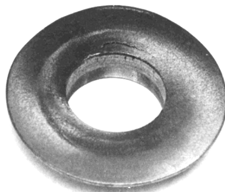
Рис. 3. Вид заготовки с трещиной в зоне максимальных деформаций
