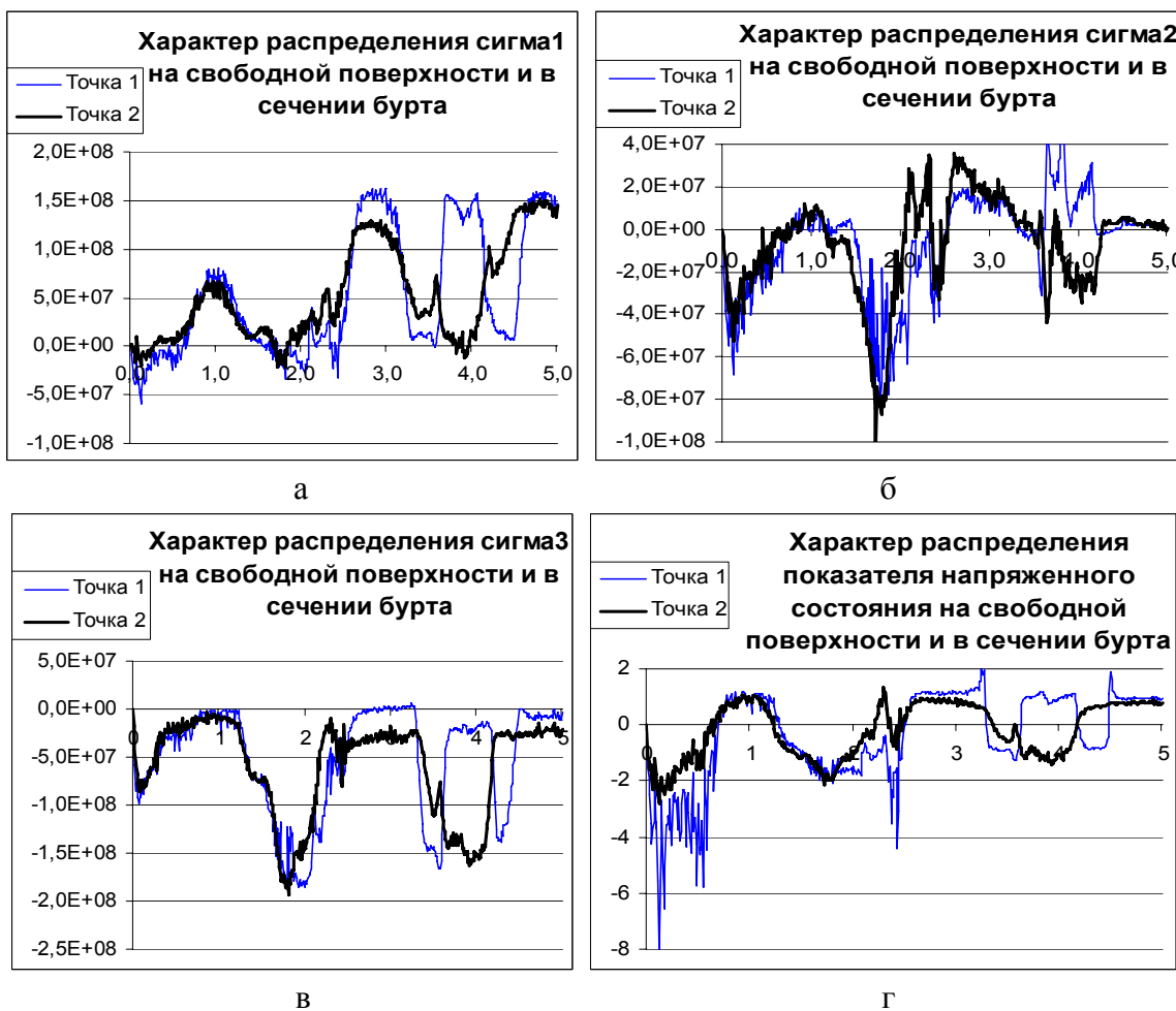
Рис. 7. Распределение компонент напряжений \sigma_1 , \sigma_2 , \sigma_3 и показателя напряжённого состояния \eta на свободной поверхности (точка 1) и в сечении бурта (точка 2)
